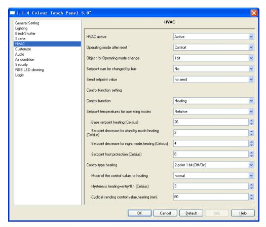
Fig. 5.5 parameter window "HVAC"
