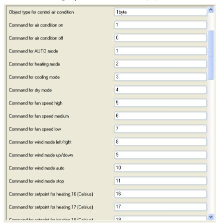
Fig. 5.8 parameter window "Air condition" (1byte)
