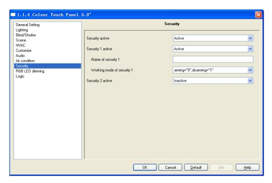
Fig. 5.9 parameter window "Security"
