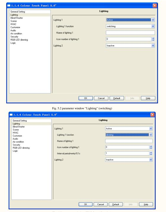
Fig. 5.2 parameter window "Lighting" (dimming)
