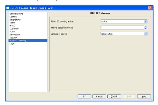
Fig. 5.10 parameter window "RGB LED dimming"
