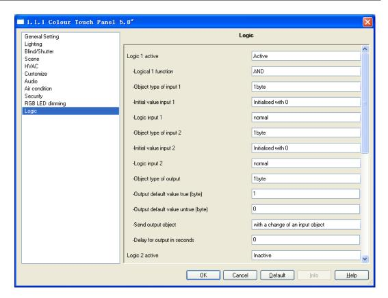
Fig. 5.11 parameter window "Logic"
