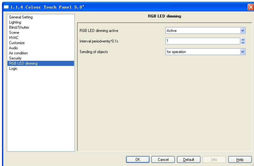
Fig. 5.10 parameter window “RGB LED dimming”
