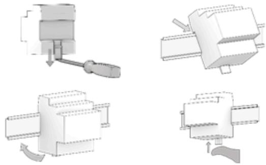
Per lo smontaggio dell'apparecchio, assicurarsi di avere scollegato le connessioni di alimentazione, la connessione di rete ethernet e di avere disinserito tutti i morsetti dai loro alloggiamenti. Mediante un cacciavite far scorrere verso il basso il dispositivo di blocco e rimuovere l'apparecchio dalla guida profilata.
